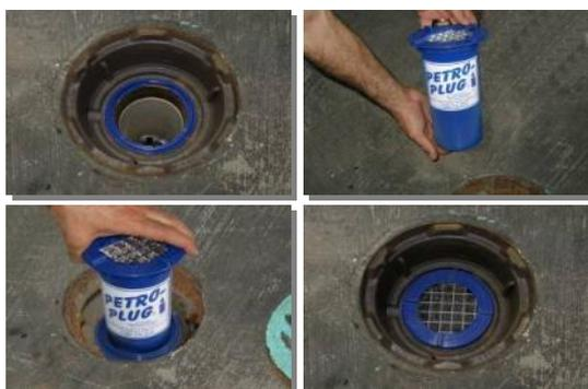
Instalado verticalmente, el **Petro-PLUG®** se adapta a las canalizaciones con un diámetro de 8 o 10 cm; se fija gracias a su junta integrada, lo que asegura una perfecta estanqueidad. Tiene un sistema antivuelta que impide que el agua vuelva a subir en caso de capa freática poco profunda. Un prefiltro estándar puede estar presente para limitar la acumulación de desechos en la entrada.
