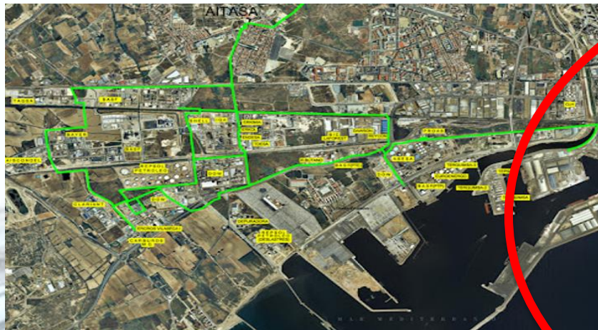
Distribució d'aigua industrial i clorada
