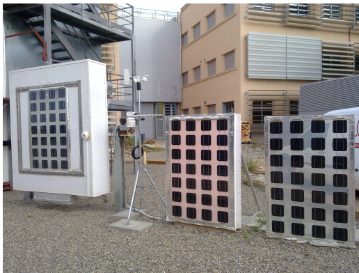
TRE-L amb dos mòduls FVde referència
