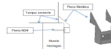
Figura 2-9 Vista actual de la base del tanque diesel JRT01 y esquema de solución
