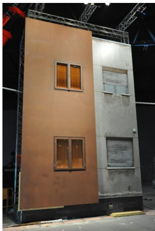
Panell de formigó armat de 700 x 250 x 3 cm de gruix, fabricat en una única peça
