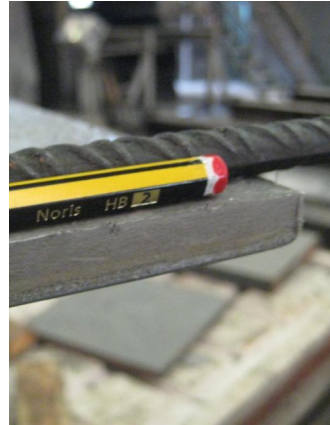
Peces de formigó armat de 10 mm de gruix
